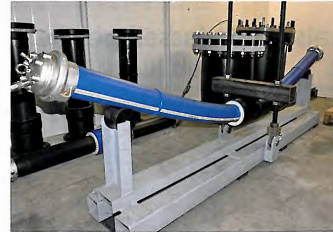
Bild 3: Druckprobe 25 bar unter Biegebelastung
